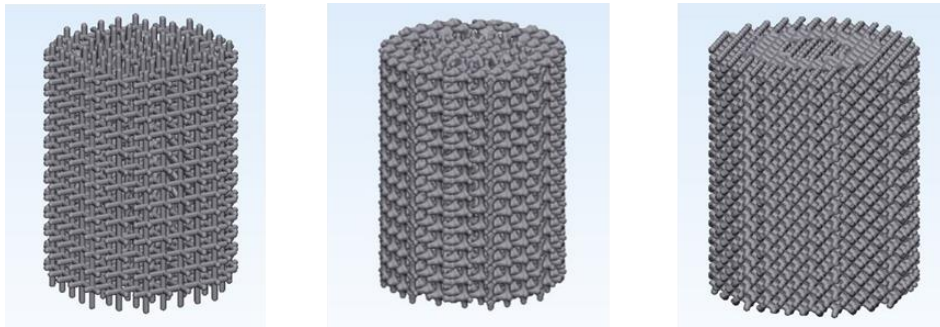
Şekil 2. Kübik birim hücresi ile oluşturulmuş hücresel yapı (a) Octahedroid birim hücresi ile oluşturulmuş hücresel yapı (b) Diamond birim hücresi ile oluşturulmuş Hücresel yapı (c)
