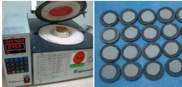
Şekil 3.14 Opak uygulanan örnekler
