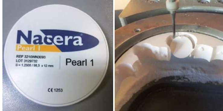
Şekil 3.8 Çalışmada kullanılan ZrO_2 blok ve bu bloktan kazıma işlemi
