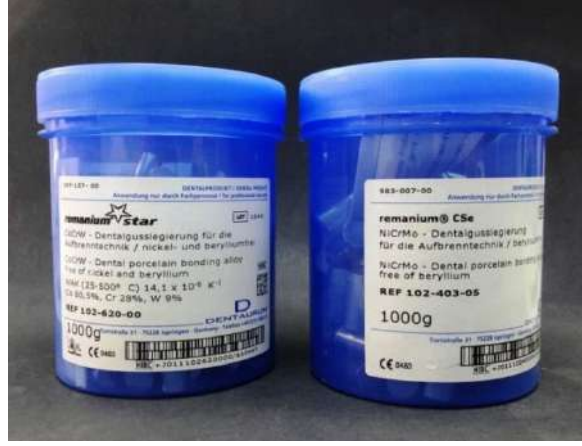
Şekil 3.4. Döküm disk ve dikdörtgen prizması örneklerin hazırlanmasında kullanılan CoCr ve NiCr dental metal alaşımları
