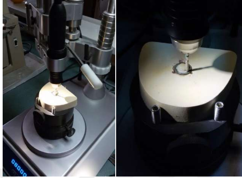
Şekil 3.21 Örneklerin paralelometre cihazında düzeltilmesi
