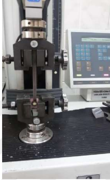
Şekil 3.33 Örneğin test cihazına yerleştirilmesi
