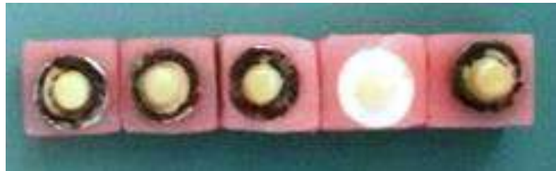
Şekil 3.32 Akrilik rezine gömülmüş disk örnekler
