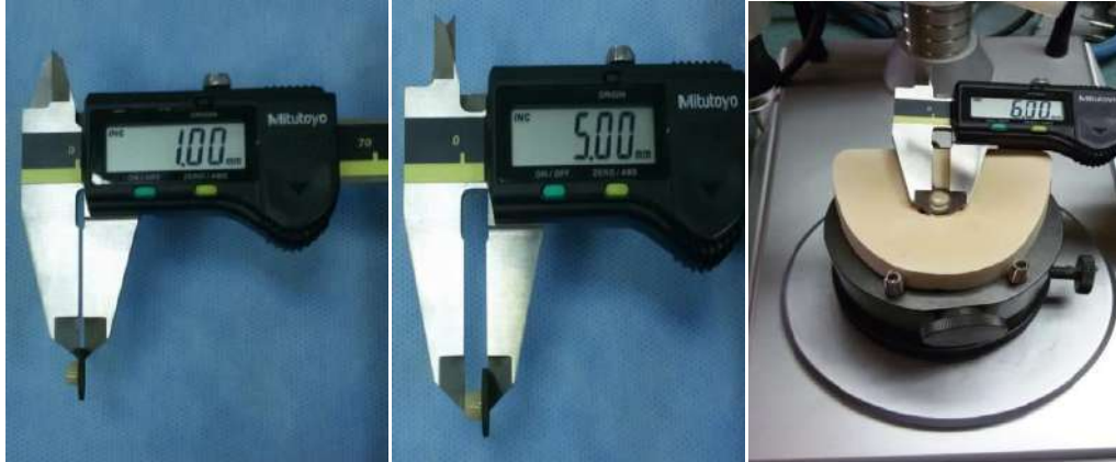
Şekil 3.22 Örneklerin dijital kumpasla ölçülmesi
