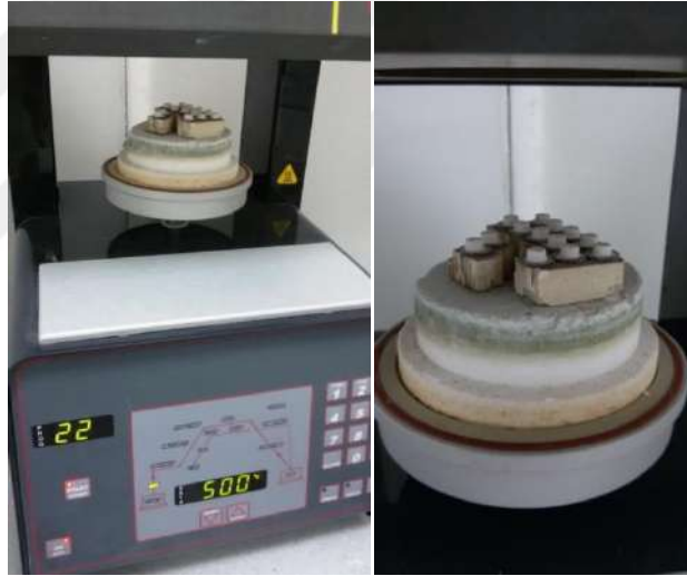
Şekil 3.20 Ti örneklerine dentin porseleni pişirilmesi
