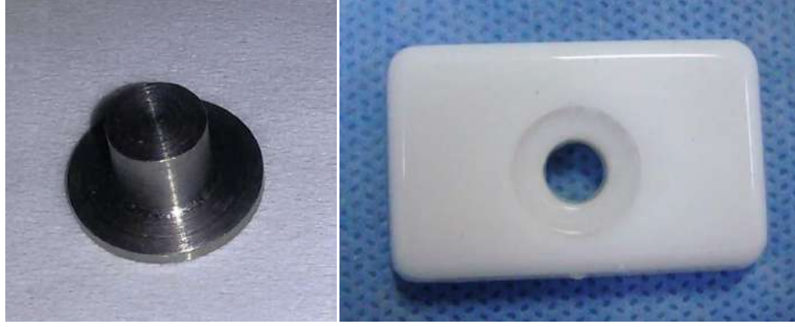
Şekil 3.11 Seramik uygulaması için üretilen metal model ve silikon kalıp.
