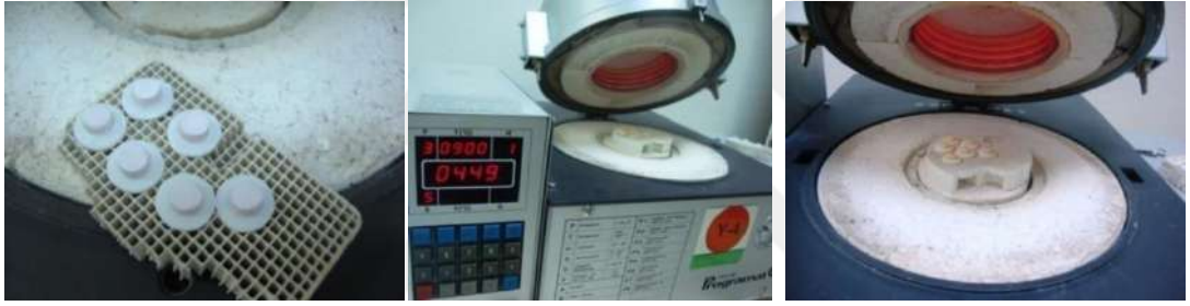
Şekil 3.17 Zirkonyum örneklerin fırınlanması
