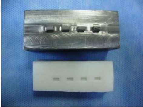
Şekil 3.1. Disk örnekler için üretilen metal modeller.
