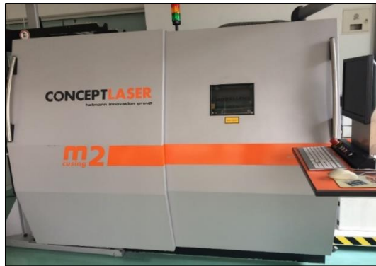
Resim 3.2. Üretimde kullanılan Concept Laser marka M2 model 3 boyutlu metal yazıcı
