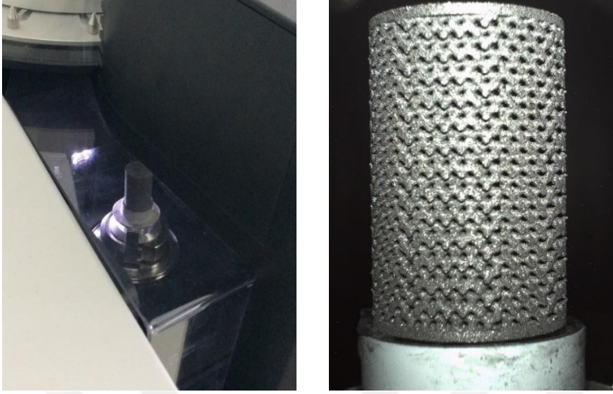
Resim 3.6. Numunenin bilgisayarlı mikro tomografi içindeki görüntüleri
