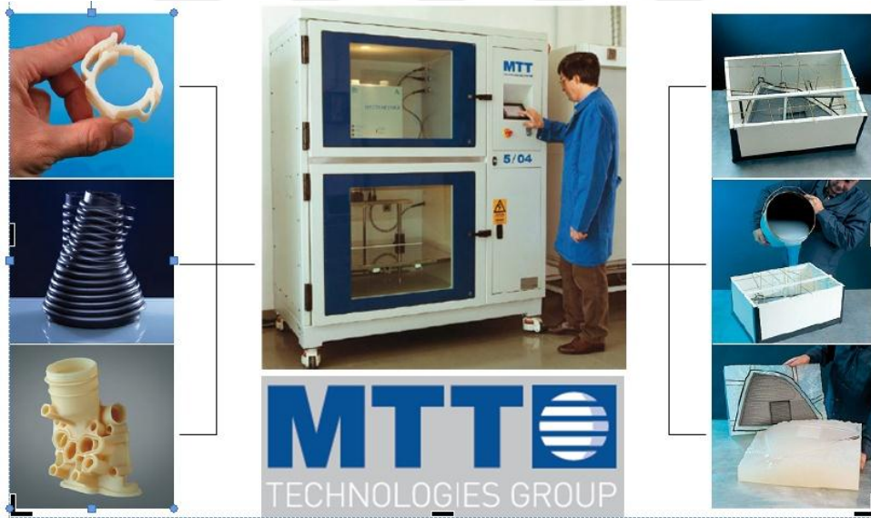
Şekil 9.3: Silikon Modelleme Makinesi, Marka (MTT), Model (5/04 with All Nylon Options) [METÜM].
