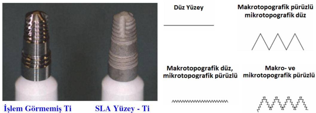
Şekil 8.1: SLA implant yüzeyi ve işlem görmemiş titanyumun karşılaştırılması [Url-7].
