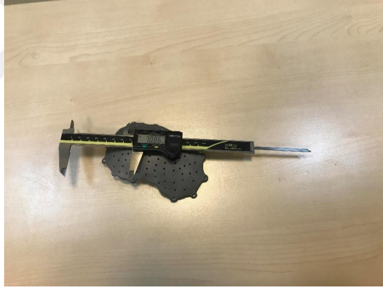
Şekil 10.4: Kumpas ile boyut kontrolünün yapılması [METÜM].
