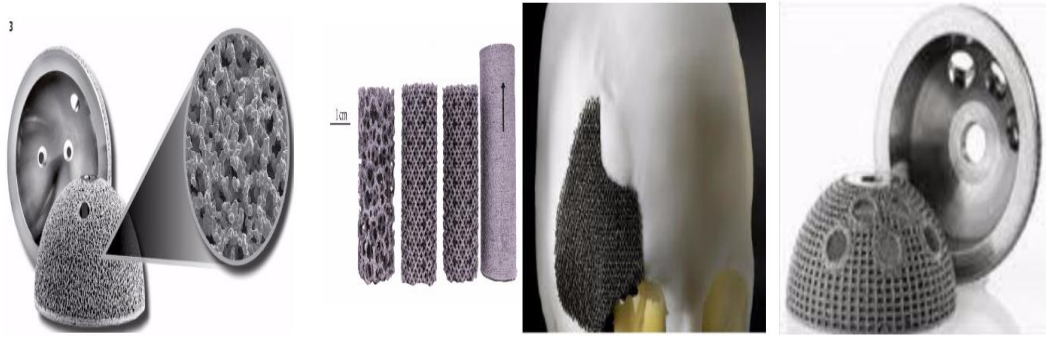
Şekil 7.16: Gözenekli kafes kaplı implantların EBM yoluyla üretimi[Url-7].
