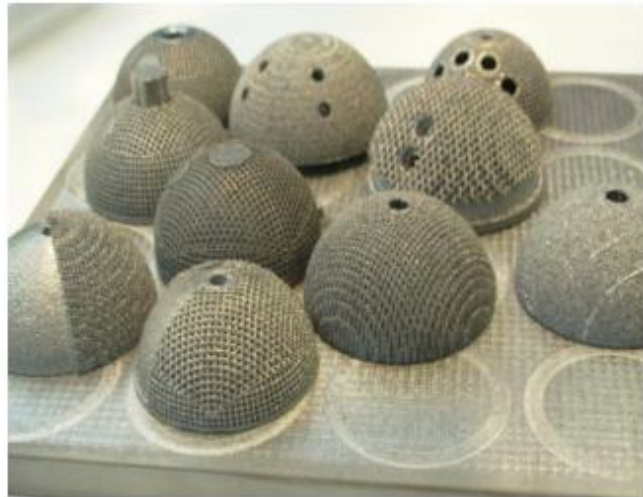
Şekil 7.15: Elektron demeti ile ergitmenin gösterimi ve kafes kaplı implantların EBM yoluyla üretimi [Url-7].
