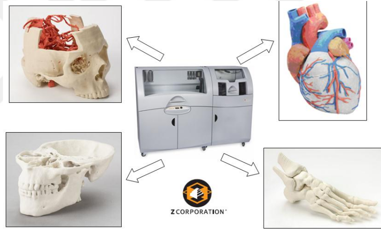
Şekil 9.1: Plastik Modelleme Makinesi (Marka: ZCORP Model: Z650) [METÜM].
