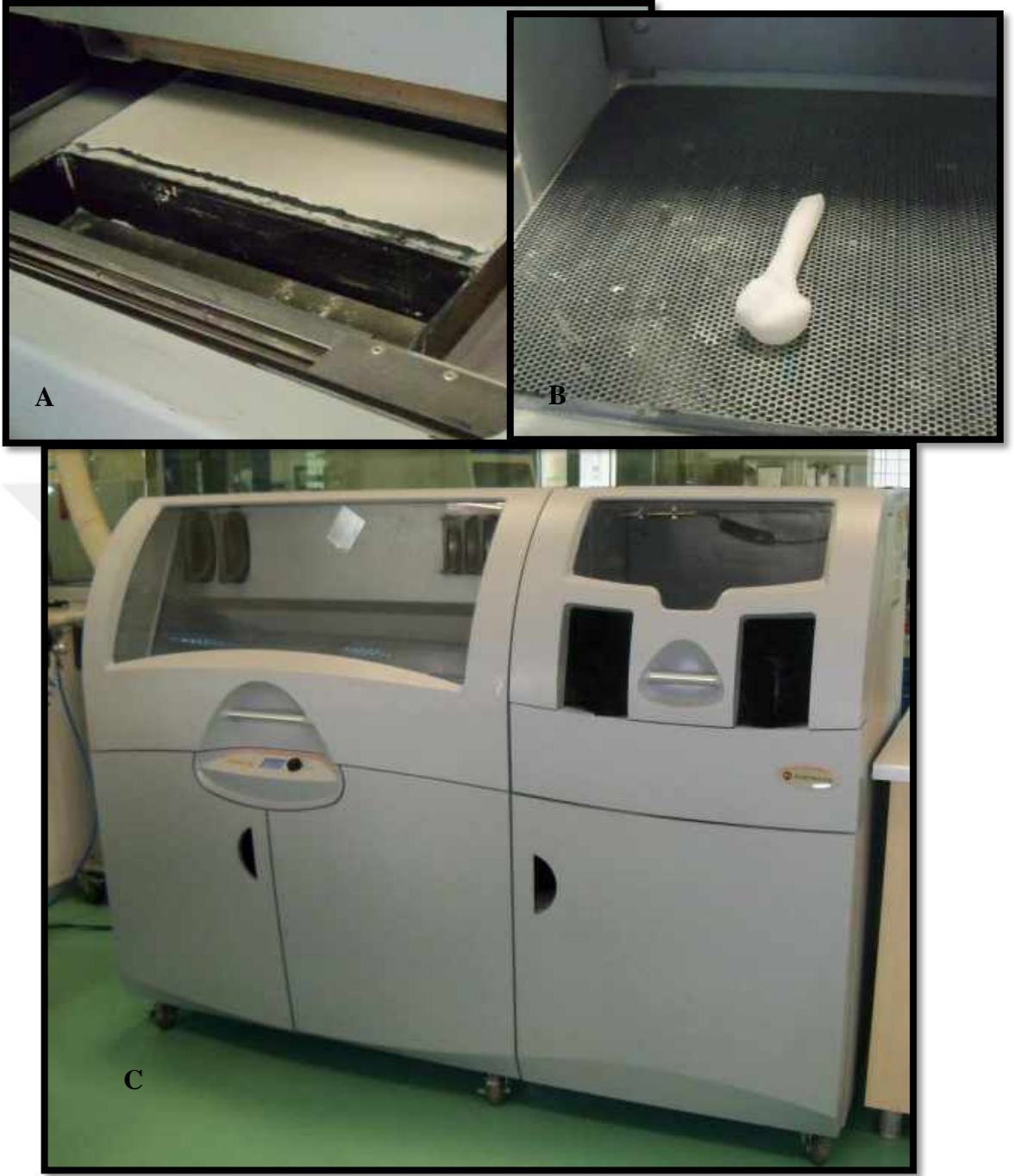
Şekil 2.66. Z printer A. Toz Yatağı B. Üretim Haznesi C. Z Printer dıştan görünüm
