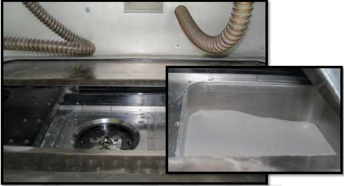
Şekil 2.64. 3D Metal Printer Cihazının Toz yatağı ve İç Haznesi
