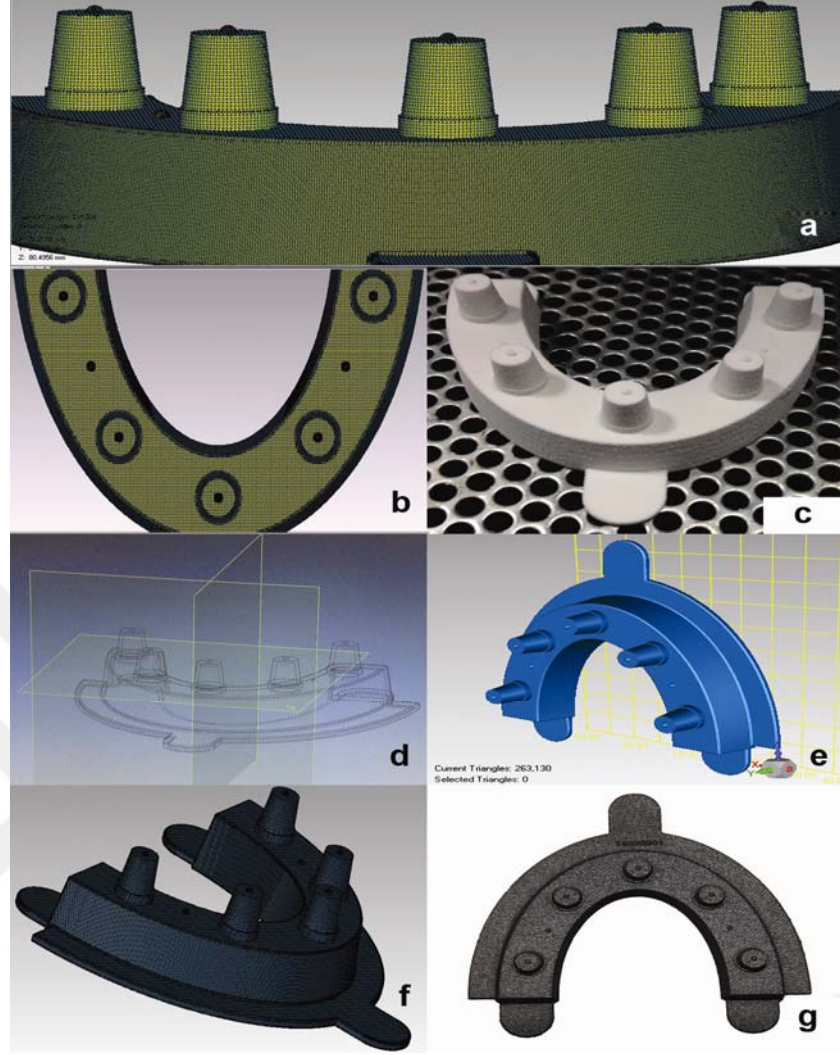
Şekil 3.6. TARKAM'ın üretilmesine kadar yapılan işlemler: a) RapidForm XOR3'te tasarımın yapılması. b) Dayanaklar ve 7 adet RN'nin üstten görünümü ve STL formatına dönüştürülmesi. c) Üretilmiş ABS ön model. d) Tasarımdaki eksik görülen bölümlerin yeniden tasarımı. e) Tasarımın farklı koordinatlarda incelenmesi. f) Tasarımın tamamlanması ve STL formatına dönüştürülmesi. g) TARKAM'ın Co-Cr'den üretilmesi.
